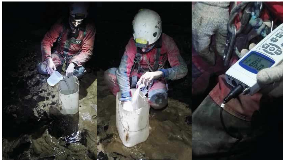
Immagini dei vari momenti di misura delle portate: riempimento del contenitore, scioglimento del sale e misura della conducibilità.
