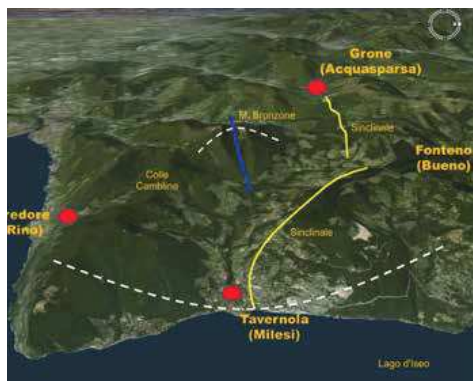
La sinclinale di Tavernola Bergamasca, con asse immergente verso Est (con la traccia del piano assiale in giallo), e la sinclinale di Grone, con asse immergente verso Ovest (con traccia del piano assiale in blu)
